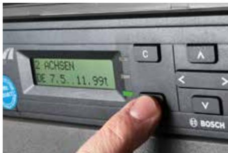
En principio, en el equipo del vehículo se guarda de forma permanente el peso máximo total que el cliente indicó al inscribir el vehículo. Si dicho peso cambiara por haber acoplado o desacoplado un remolque, antes de iniciar el viaje habrá que adaptar el peso máximo total en el OBU. Después de un cambio de encendido siempre se visualiza la categoría por peso del último viaje.
